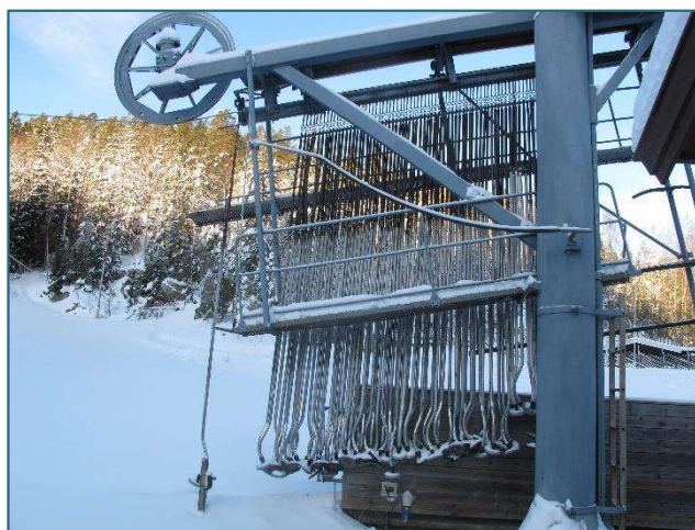
Figur 11: Teleskopmedbringere med skål. Foto: SHK
